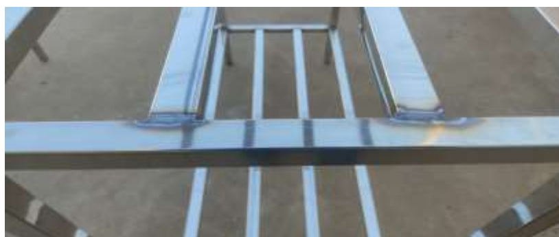
Figura 10. 1º Etapa – Zona termicamente afetada após processo de soldagem.
