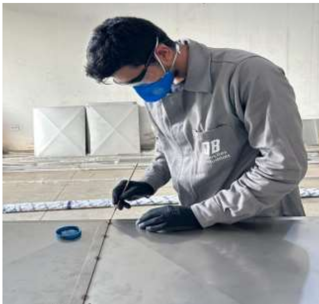
Figura 11. 1º Etapa – Aplicação do gel decapante na zona termicamente afetada.
