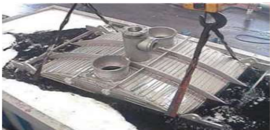
Figura 7. Método de decapagem por imersão.
