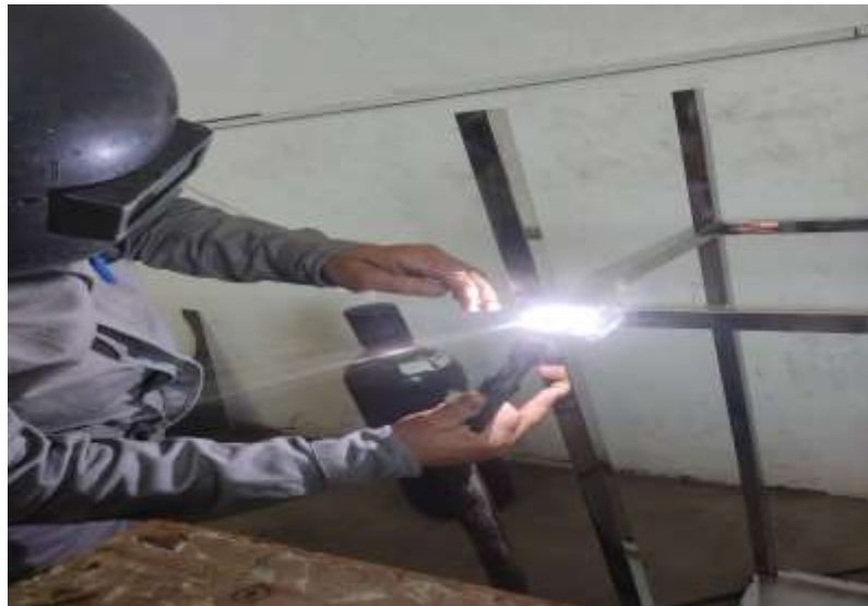
Figura 9. 1º Etapa – Processo de soldagem do aço inoxidável 304.
