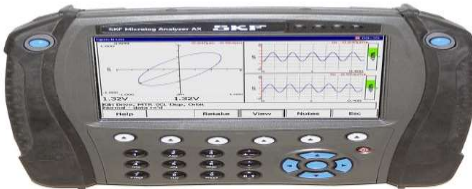
Figura 2 – Coletor de Vibração SKF Microlog Analyzer serie AX
